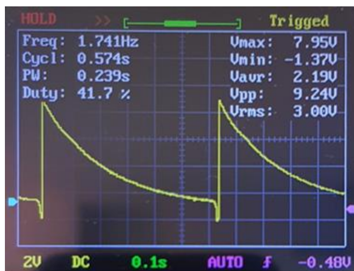
Rys. 42. Przebieg napięcia baza-emiter tranzystora Q2
