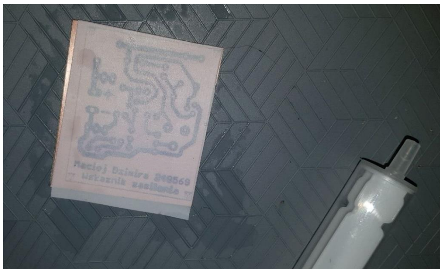
Rys. 28. Przenoszenie tonera z papieru kredowego na laminat z wykorzystaniem roztworu
