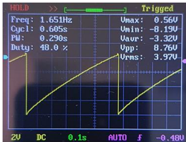
Rys. 41. Przebieg napięcia baza-emiter tranzystora Q1
