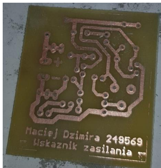
Rys. 31. Wytrawiona płytką z przewierconymi otworami na komponenty
