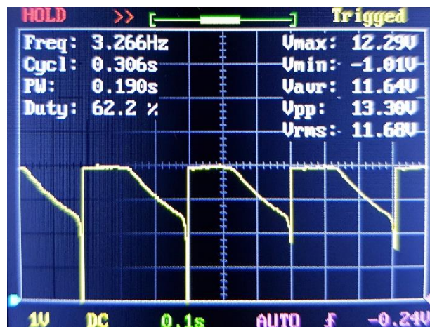
Rys. 19. Przebieg napięcia baza-emiter tranzystora Q2
