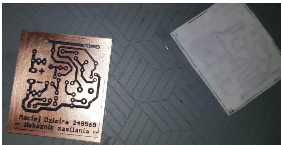
Rys. 29. Toner przeniesiony na laminat
