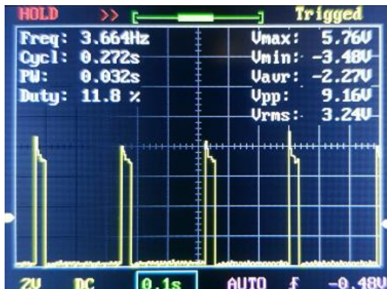
Rys. 47. Przebieg napięcia na rezystorze pomiarowym 1 k \Omega
